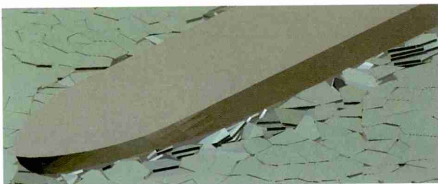
图 11 扩展多面体碎冰单元与船体结构作用
