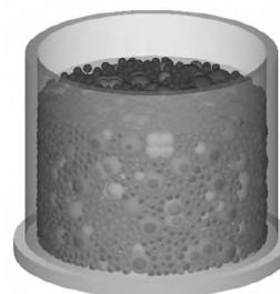
图 14 含沙铁路道砟变形模量的离散元计算
